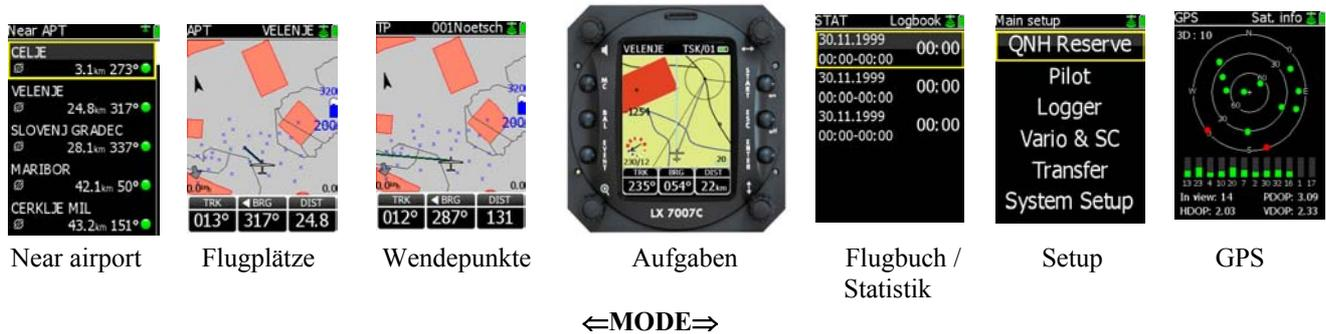
Die Menüs APT (Flugplätze), TP (Wendepunkte) und Task (Aufgaben), haben Unterseiten die mit dem UP/DOWN-Drehschalter (⬆) ausgewählt werden, genauso STATISTIK und SETUP.
