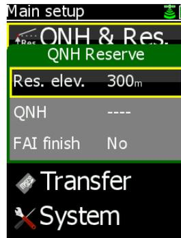
**Res. Elev.** ist die feste Sicherheitshöhe, d.h. die Höhe, in der der Pilot über dem gewählten Ziel ankommen möchte. Diese Höhe wird zur errechneten Endanflughöhe addiert. D.h. der Endanflug ist auf Null auszuführen, um in der Sicherheitshöhe anzukommen.
