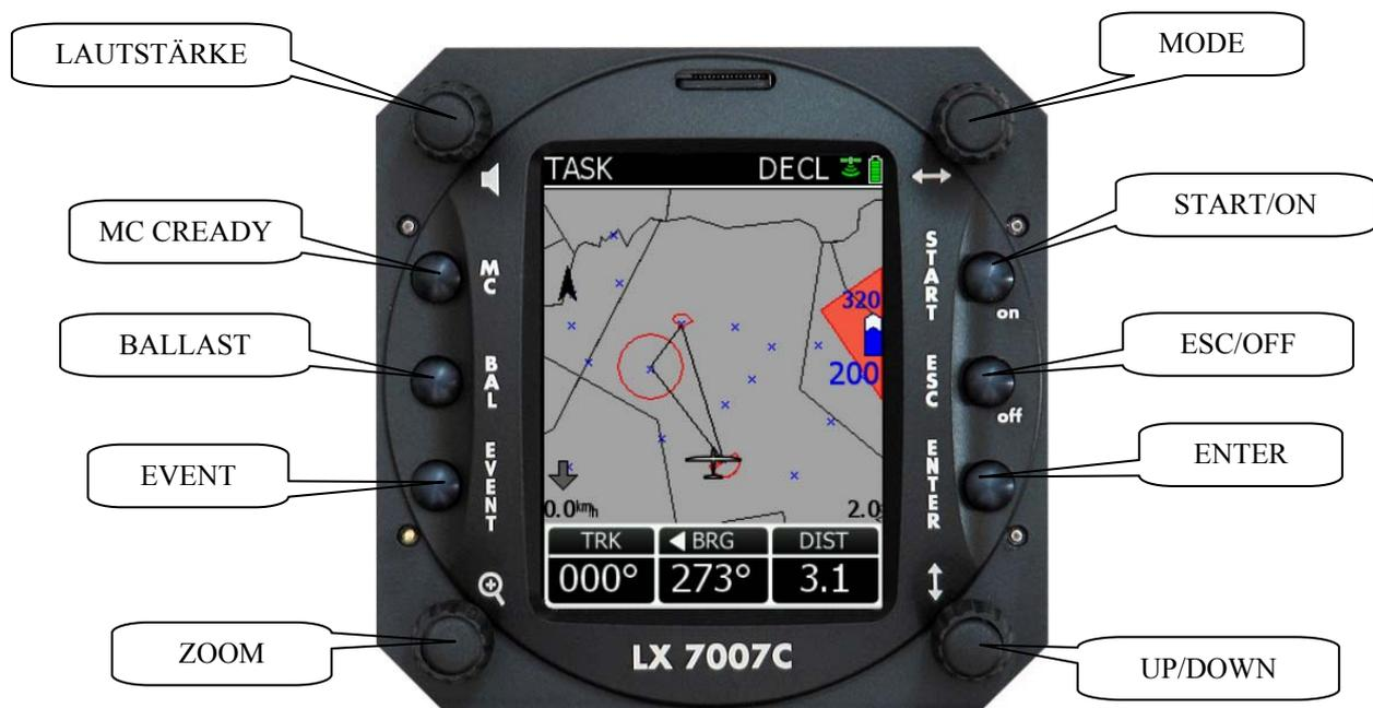
Die Varioanzeige (LX7007 USB-D) besitzt keine Bedienungselemente, d.h. alle notwendigen Eingaben werden am Rechnerteil (LX7007 C DU) durchgeführt.
